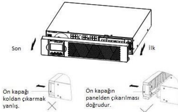
Şekil 8 akü kabin Ön Kapağının Çıkarılması
