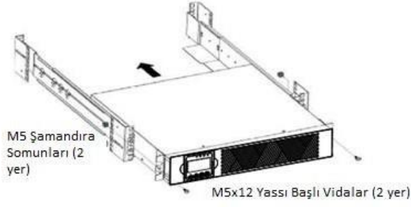
Şekil 4 Kabinin Ön Kısmının Sabitlenmesi
