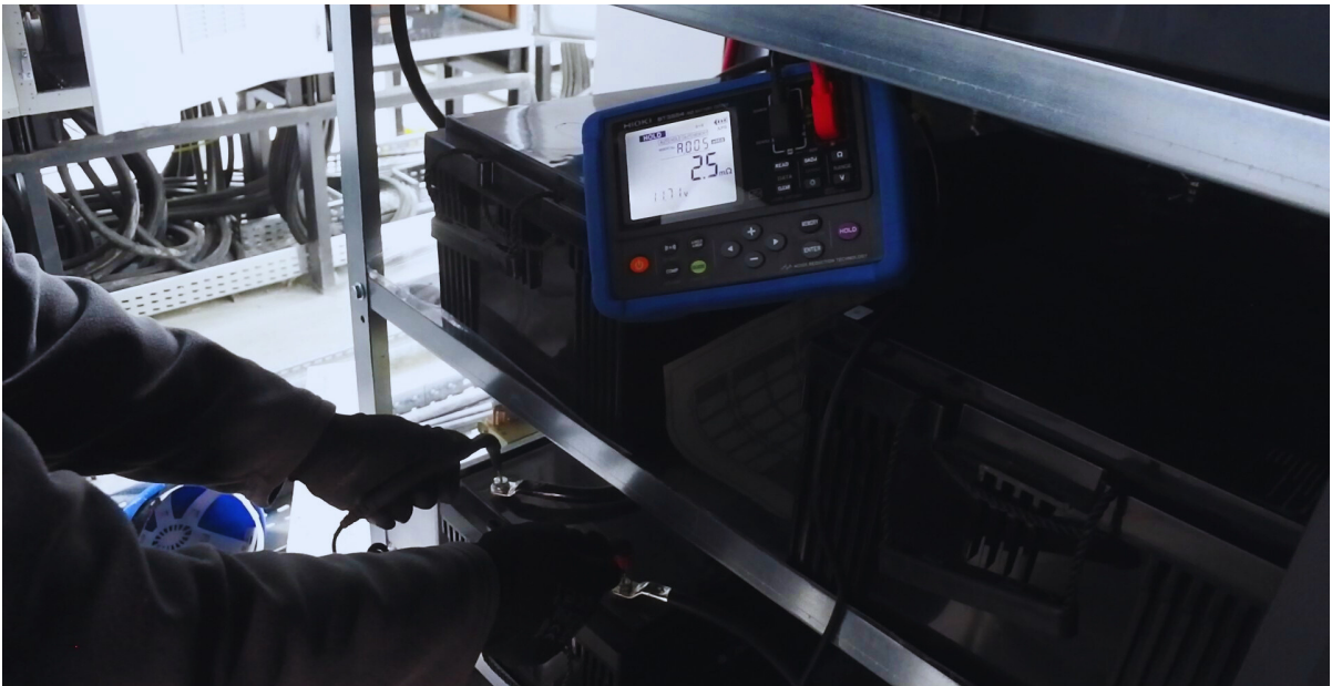
Görsel 5 – Hioki cihazı ile Akü Kapasite Testi
