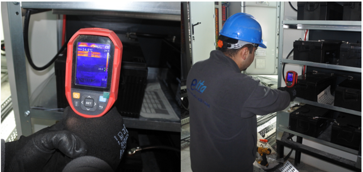
Görsel 7 – Akülerin sıcaklık değerleri termal kamera kullanılarak ölçülmesi
