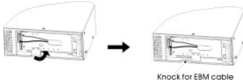
Şekil 9 UPS Kablo Çıkıntısının Çıkarılması
